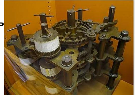
Часть разностной машины Чарльза Бэббиджа, собранная после смерти учёного его сыном из деталей, найденных в лаборатории отца.
