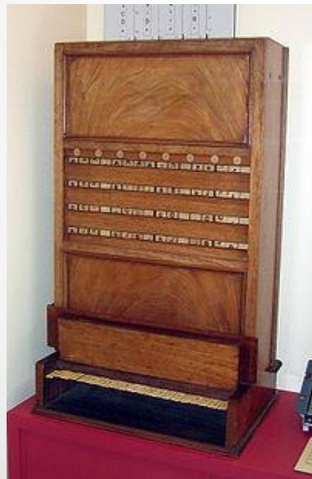
Логическое пианино – механический компьютер с клавиатурой, который позволял строить логические тесты и показывал как заключения вытекают их предпосылок.
